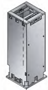
Sezione delle colonne: 1100 mm x 1100 mm
