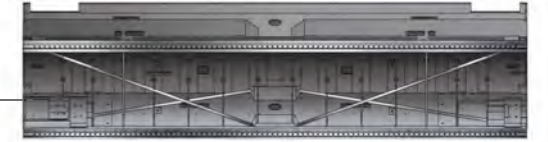
Sezione della trave trasversale: 1030 mm x 1305 mm
